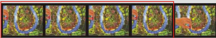
7.5 oder 15 Bilder pro Sekunde (wie bei Geräten anderer Hersteller): Bilder werden mehrfach ausgegeben. Bewegungen sind schwer zu verfolgen
