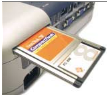
Über einen Adapter lassen sich auch Compact-Flash-Karten in den PC-Card-Schacht einsetzen
